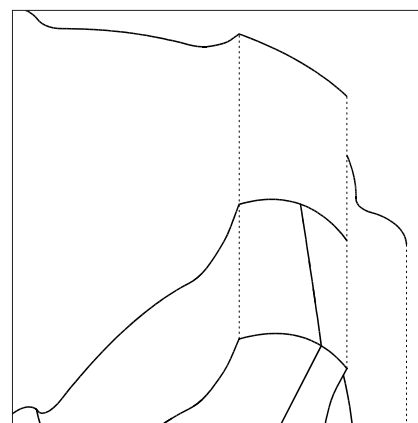
Figura 9.2. Rappresentazione della medesima porzione di trompe, senza linee di "tassellazione". In questo caso, però, quando si eliminano le linee nascoste in AutoCAD, alcuni spigoli non saranno rappresentati. Nell'esempio, gli spigoli mancanti, del resto di semplice reperibilità, sono stati aggiunti manualmente ed evidenziati con linee punteggiate.
